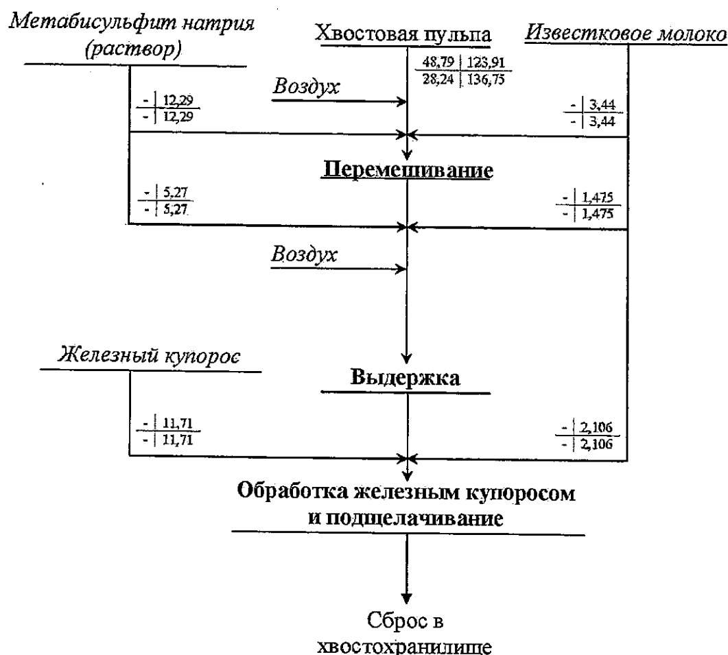
Рисунок 2 Технологическая схема процесса обезвреживания хвостов сорбционного цианирования.
